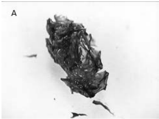
圖5 RF氣凝膠之外觀圖。
