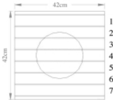
圖 2. 金屬和砂粒夾雜物撒佈之部位示意圖
